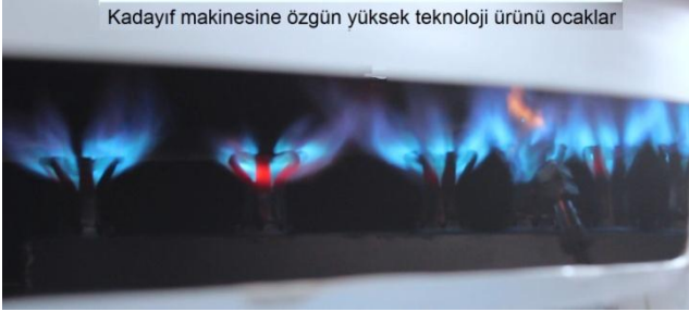
Şekil 6.3 Ocaklar Mavi alev çıkarmalıdır
